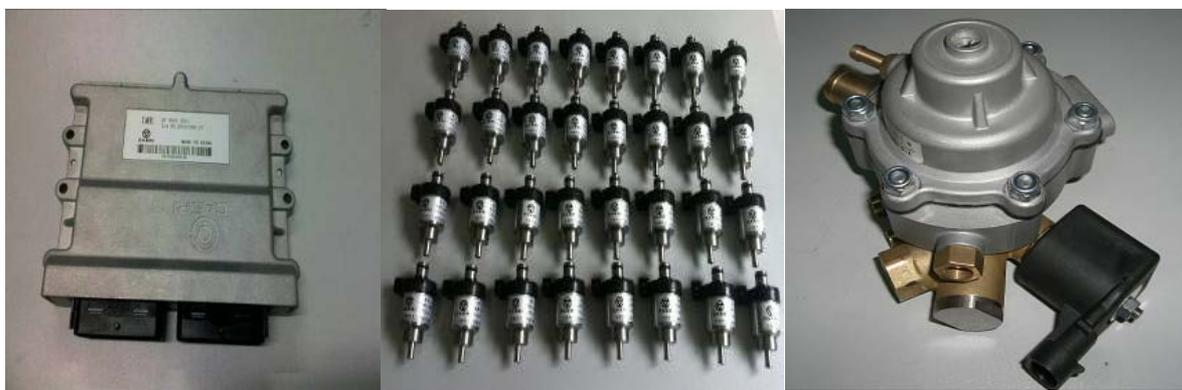
中国汽研发动机ECU、喷嘴、减压器
